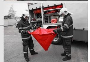
Mithilfe der Ösen kann der Trichter direkt an der Verrohrung eingehängt werden
