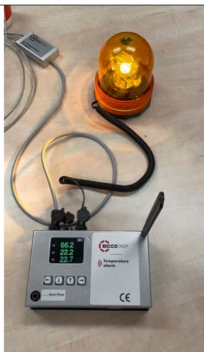
Maják ohlašující překročení stanovené teploty
