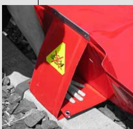
Záchytnou vanu je možné umístit pod vlak nebo jiné drážní vozidlo dvěma způsoby: napříč přes koleje nebo podélně do vnitřního prostoru mezi kolejemi. Oba způsoby použití byly podrobeny náročným testům.
