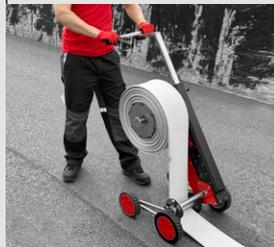
Roller 7 – Aufwicklung beim Gehen – das gesamte Gewicht des Schlauches wird vom 4-Rad-Fahrgestell getragen
