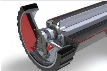
Eine Spezialübersetzung ermöglicht das Streuen durch Vorwärtsbewegung. Bei Rückwärtsbewegung wird das Streuen automatisch gestoppt (Bindemittelsparung).
