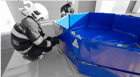
Die Sechseck-Plane wird nach dem Falten mittels spezieller Haken gesichert
