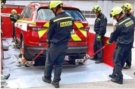
Die Seitenwände des Containers können erst nach dem Abstellen des Autos im Raum des Containers endgültig montiert werden. Dann wird der Container gefüllt und das Auto überschwemmt.
