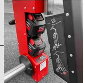
Elektromotorischer Antrieb mit Akkubatterie
