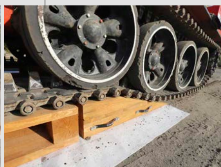
Detail nájezdu pásového vozidla na dřevěnou rampu
