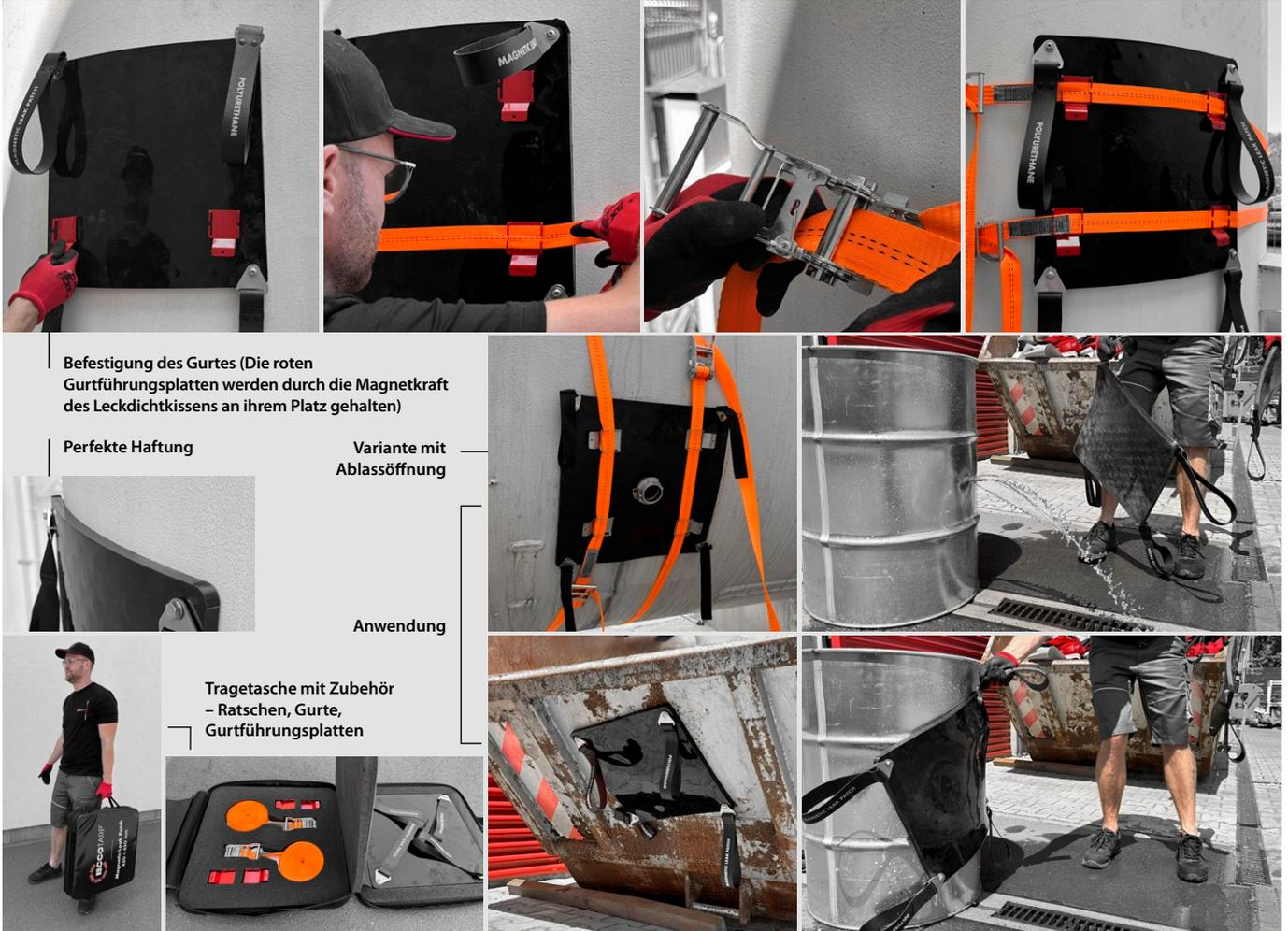
Befestigung des Gurtes (Die roten Gurtführungsplatten werden durch die Magnetkraft des Leckdichtkissens an ihrem Platz gehalten)
