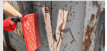
Magnetisches Leckdichtkissen mit Teflon-Schutzmembran, die eine erhöhte chemische Beständigkeit sicherstellt
